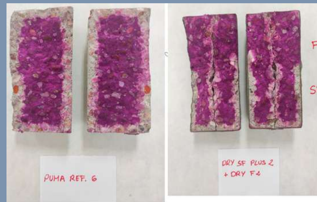
Figura 4. Fotografías realizadas tras la exposición acelerada durante 140 días al 3% de CO 2 , rotura y rociado con fenolftaleína.
